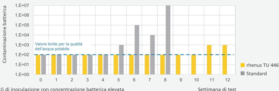
Test con cicli di inoculazione con concentrazione batterica elevata (test di laboratorio, dip slide dopo 48 h)
